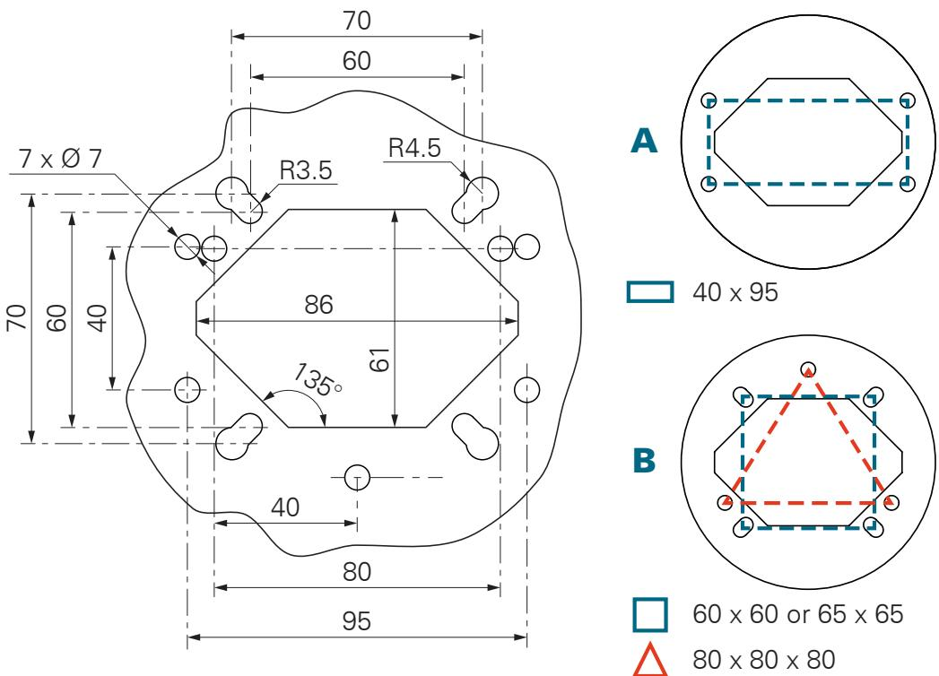
提供两种安装孔尺寸。在箱体顶端
